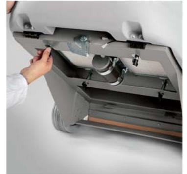
El filtro a panel se extrae fácilmente para limpiarlo correctamente a fondo o sustituirlo, sin el uso de herramientas
