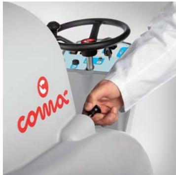
El sacudidor eléctrico del filtro con detención de la aspiración asegura la correcta limpieza del mismo, directamente desde el puesto de conducción
