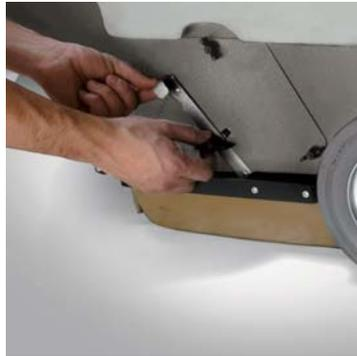
La regulación de la altura del cepillo central se realiza fácilmente, sin el uso de herramientas
