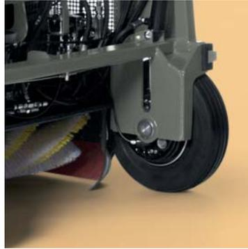
Las ruedas de gran diámetro, además de reducir los esfuerzos mecánicos, favorecen la comodidad. Su robusto soporte contribuye a mantener inalteradas las características de funcionamiento. Ambas versiones están equipadas de serie con frenos de control hidráulico
