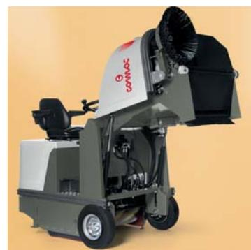
La presión y la regulación de la altura del cepillo central se controlan simplemente con el mando colocado cerca del cepillo. Por tanto, la regulación de la altura del cepillo en función del desgaste puede realizarse con gran facilidad. Esta operación permite alargar el ciclo de vida del cepillo
