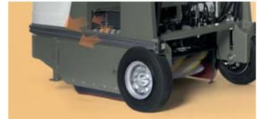
La descarga del aire aspirado se realiza a través de las rejillas colocadas en zonas muy altas de la máquina. Esto permite no levantar el polvo depositado en la superficie que circunda la propia máquina garantizando de esta manera resultados de limpieza excelentes
