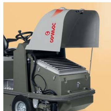
El simple control del aceite o el cambio de filtros, por ejemplo, en la versión motorizada se han reducido a una facilidad extrema. En la versión B la caja que aloja los dispositivos eléctricos está colocada en la zona central para permitir un fácil y rápido control de los mismos y del nivel del líquido en los elementos de las baterías. Se puede instalar un cajón baterías con una capacidad de hasta 480 Ah C5 (versión CS90B)
