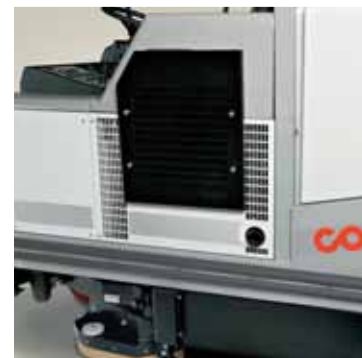
C130 Diesel - Radiador con ventilador soplador
